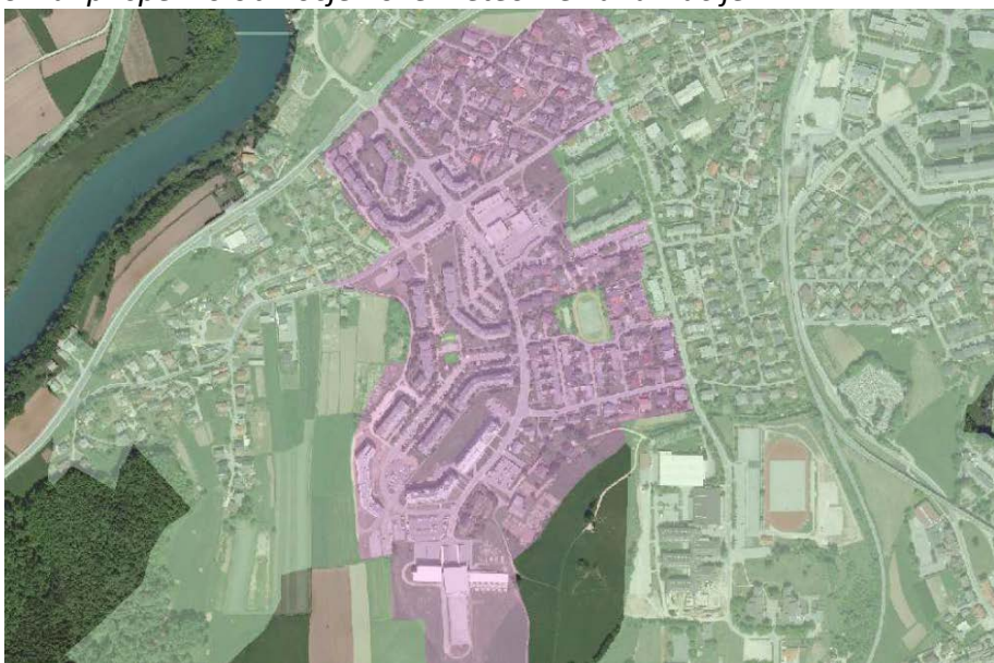
Slika: prispevno območje nove meteorne kanalizacije
