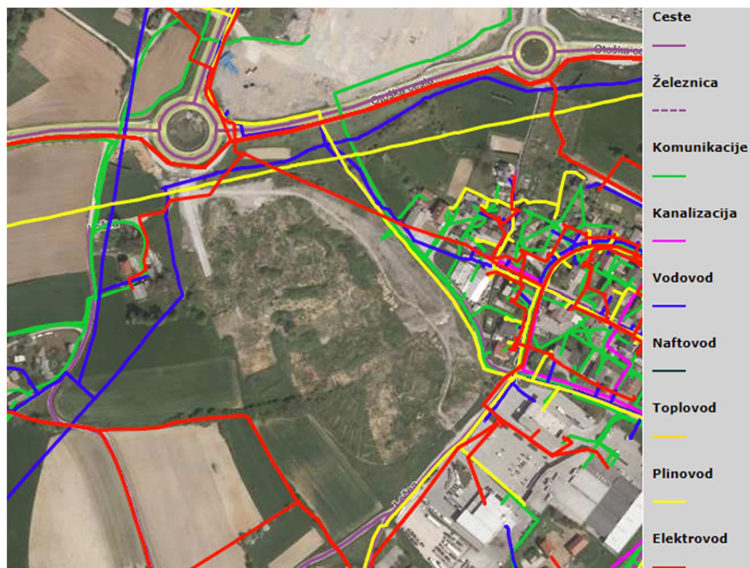
Slika 14: Prikaz gospodarske javne infrastrukture na obravnavanem območju (vir: PISO, november 2021) Po severnem robu območja poteka plinovod prenosni plinovod M4, MRP Krško - MRP Novo mesto s premerom 400 mm in tlakom 50 bar, ki se zaradi gradnje krožnega križišča K2 (po DPN) prestavi, kot je razvidno s spodnje slike.
